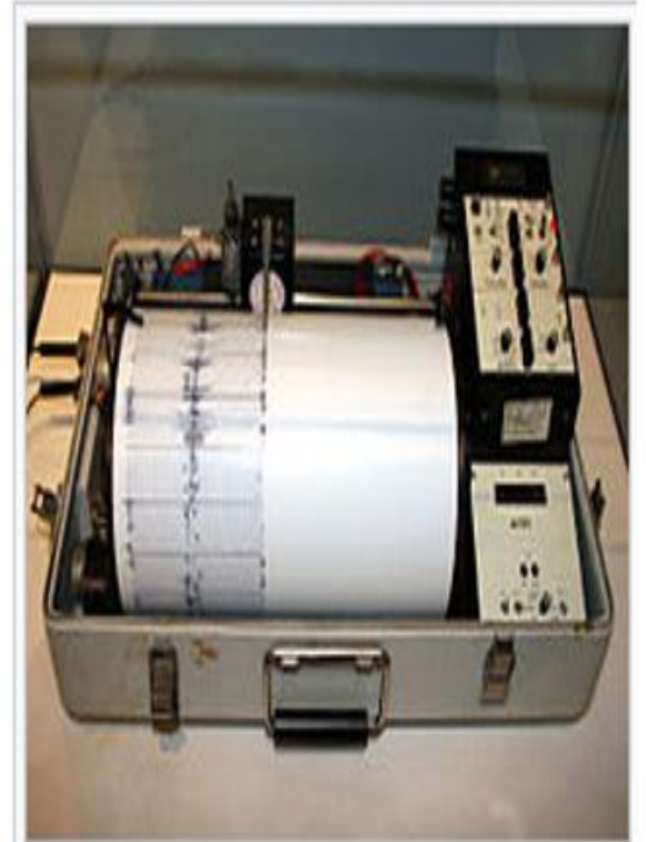
Sismógrafo quinemétrico del Departamento del Interior de Estados Unidos.
