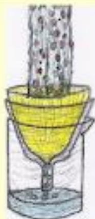
Para separar un **sólido** mezclado con un **líquido** en el cual no es soluble. El filtro permite el paso del líquido y retiene las partículas sólidas.
